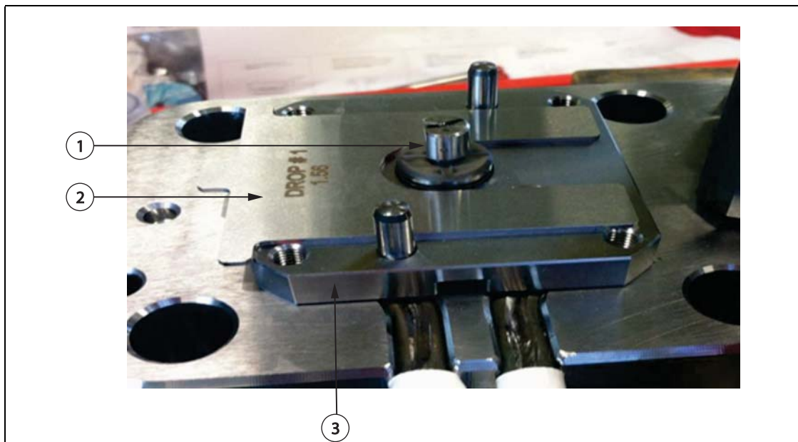
图 6-8 拆卸 / 安装薄垫片
