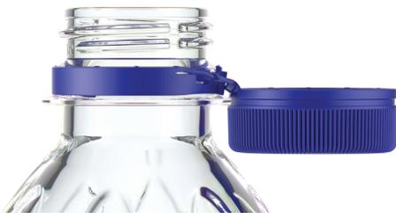
Este cierre se produjo para un cuello PCO 1881 estándar que cuenta con un anillo de soporte de gran diámetro. Una ranura integrada dentro de la carcasa de cierre permite que se bloquee en su lugar sin interferencia del anillo de soporte. Este diseño destaca la flexibilidad de los diseños de cierres atados para satisfacer sus diseños de botella existentes.
