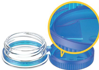
Dieser patentierte, innovative Bügelverschluss besitzt einen integrierten Nocken an der Oberseite. Diese Funktion sorgt für eine positive Ausrichtung der Schale zur Mündung und ermöglicht ein einfaches Wiederverschließen mit einer fließenden Bewegung.
