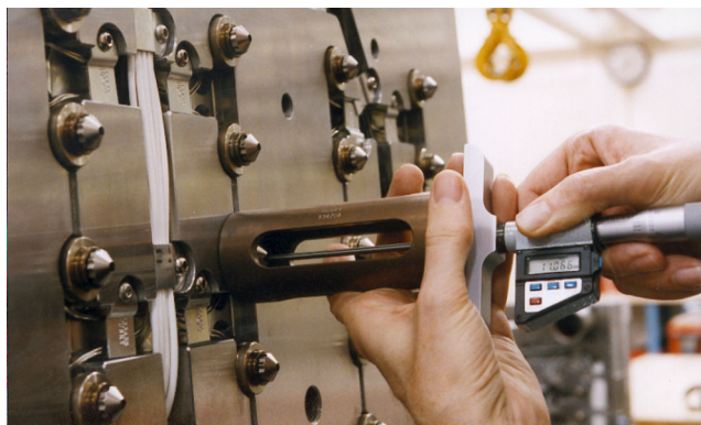
Figura 5-29: Medição da altura do bico de injeção
