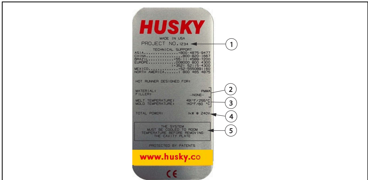
Figura 1-1: Placa de identificação da câmara quente (exemplo)
