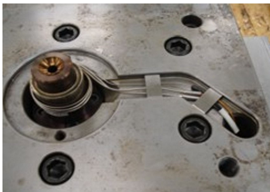
Figure 5-17 : Fil enroulé autour de l'élément chauffant (exemple)
