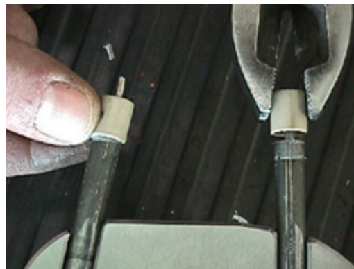
Figura 6-106: Rimozione e installazione delle boccole in PEEK
