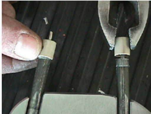
図 6-88: PEEK ブッシュの取外し取付け
