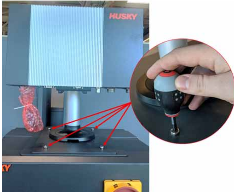
図 15-33 オルタナティブオペレーターインターフェース-ネジを取り付ける
