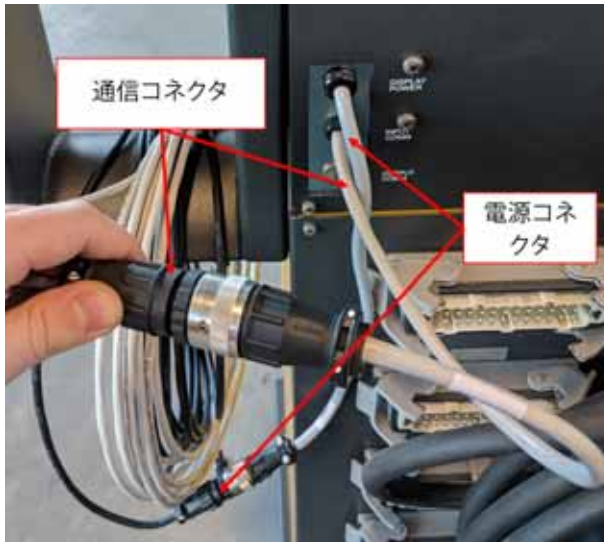
図 15-28 リモートオペレーターインターフェース-メインフレームのケーブル接続
