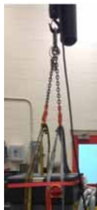
図 1-1 ストラップを持ち上げ装置に取り付ける
