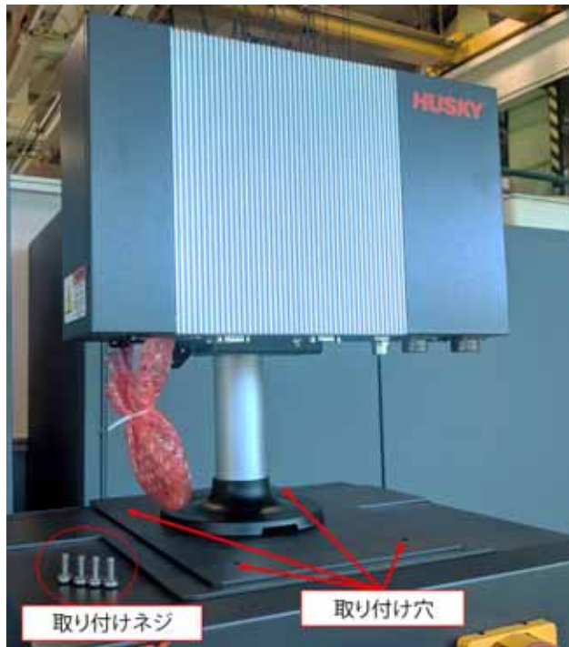
図 15-32 オルタナティブオペレーターインターフェース-取り付け穴
