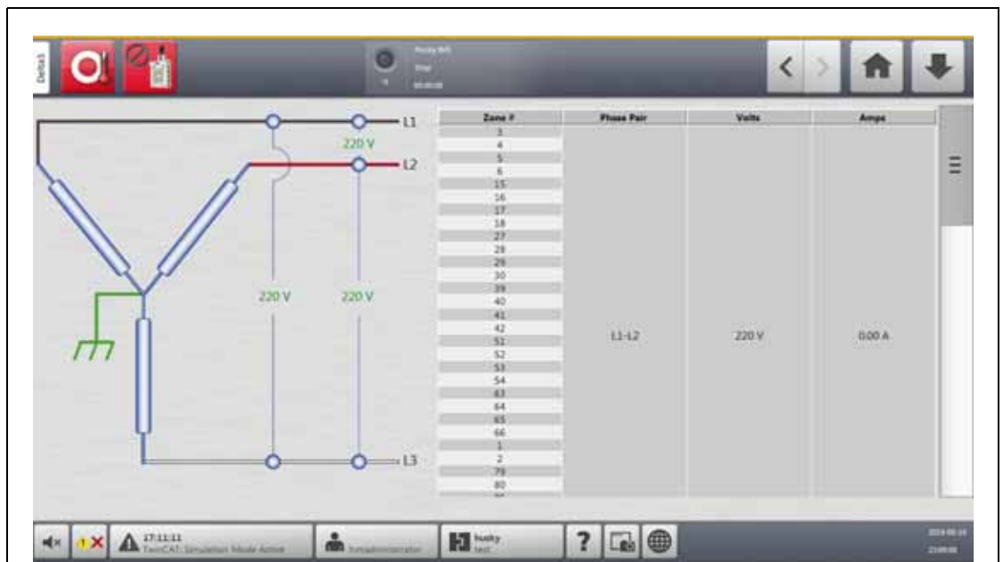
图 10-20 统合 TX 供给电压画面
