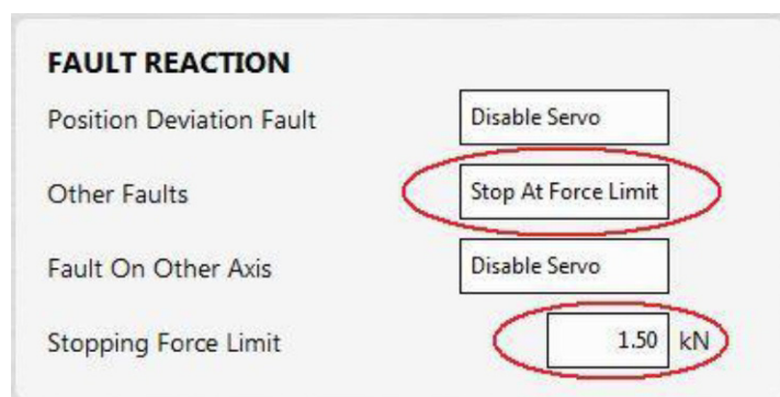
Rysunek 2-16 Ustawić oś na regulowane zatrzymanie
