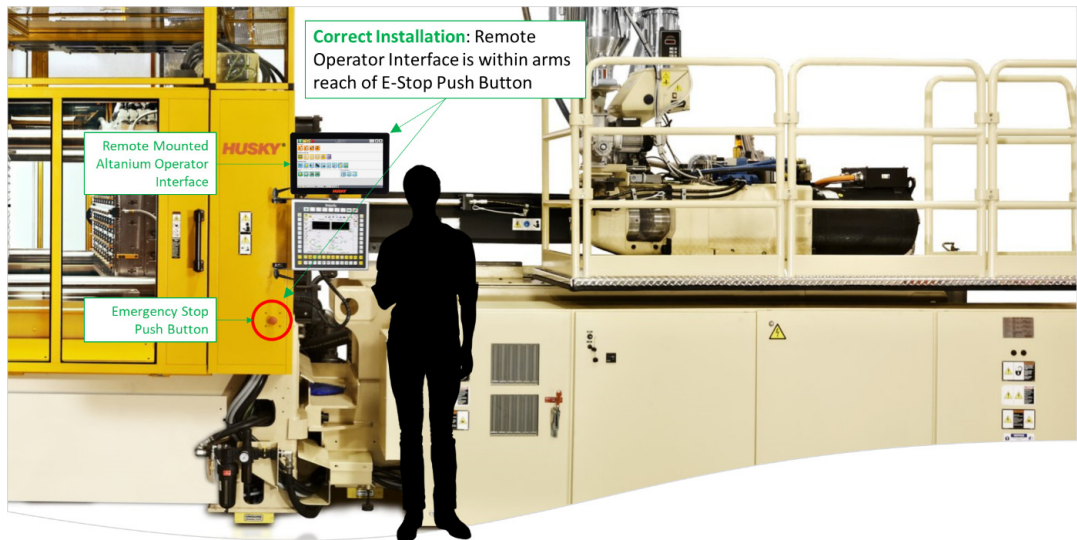
Ábra 2-8 A távoli kezelői interfész helyes telepítési pozíciója
