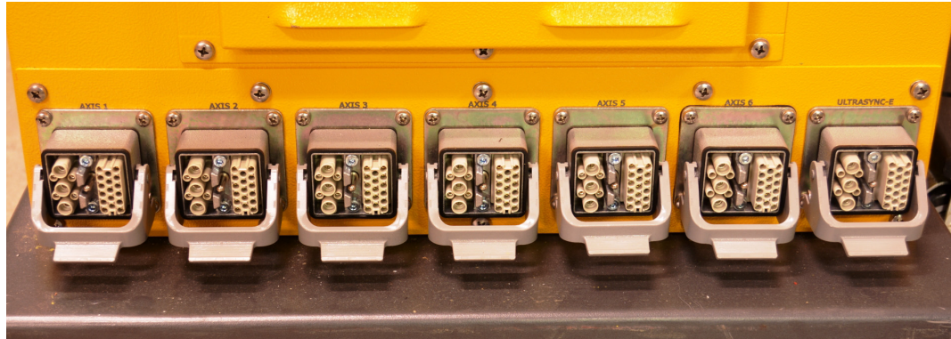
Ábra 2-18 Szervomotor (tengely) csatlakozások
