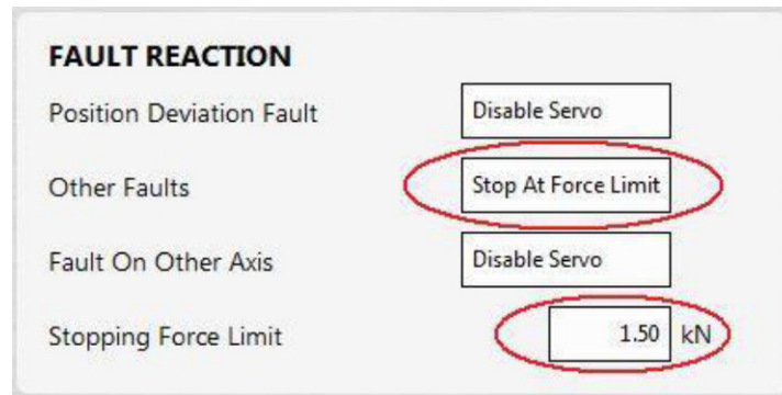
Ábra 2-16 Tengely beállítása vezérelt megálláshoz
